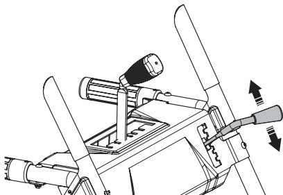
Для регулировки поворота желоба и дальности выброса снега используйте соответствующие рычаги. Внимательно следите за траекторией выброса снега.
