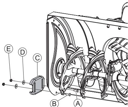
Для предохранения от повреждений частей ковша снегоуборочной машины установите башмаки по его обеим сторонам. Используйте детали крепежа из бокса №16: (А) болт M8×25 – 2 шт.; (В) болт M8×20 – 2 шт.; (Д) гроверная шайба D8 – 4 шт.; (Е) Гайка M8 – 4 шт.
