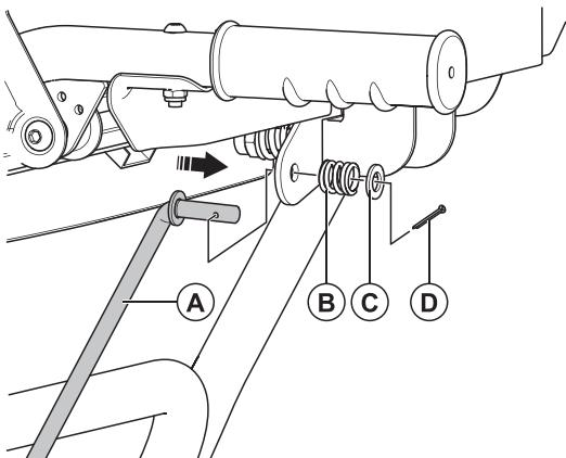
Установите на верхней рукоятке в приемное отверстие рычага переключения передач тягу (A), используйте крепёжные - бокс №14: (B) пружина - 1 шт.; (C) стопорное кольцо - 1 шт.; (D) шплинт - 1 шт.
