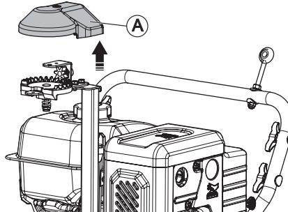
Снимите верхнюю крышку открутите установите и закрепите желоб, используя крепеж из бокса №10: (А) болт M6x12 – 1 шт.
