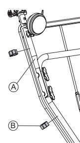
Установите фонарь освещения для этого установите его на скобу верхней рукоятки и прикрепите, используйте крепежные элементы – бокс №5: болт M6x40 – 1 шт.; гайка M6 – 1 шт
