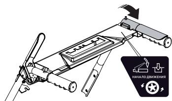
Нажмите на рычаг привода хода по направлению к ручке управления, снегоуборщик начнет движение. Для отключения привода движения отпустите рычаг.
