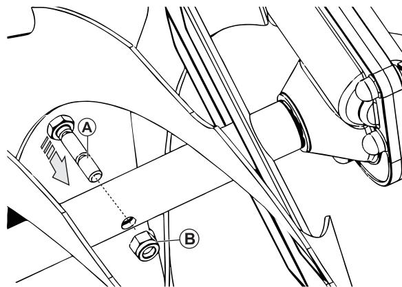
Шнеки крепятся к валу с помощью предохранительных (резных) штифтов. В случае столкновения шнека с посторонним предметом или ледяным затором, штифты срезаются и шнек перестает вращаться, предотвращая повреждения других частей снегоуборщика.
