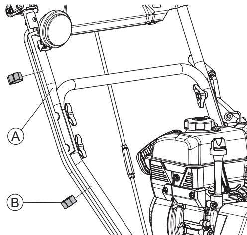
После установки верхней рукоятки закрепите трос привода шнека при помощи пластиковой клипсы из бокса №7.
