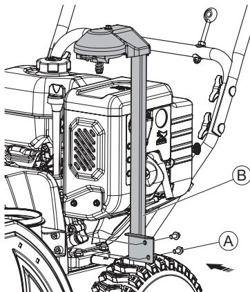
Установите поворотный механизм (В) на кронштейн снегоуборщика и закрепите при помощи болтов. Используйте крепёжные элементы из бокса №8: (А) болт M8×16 – 2 шт.
