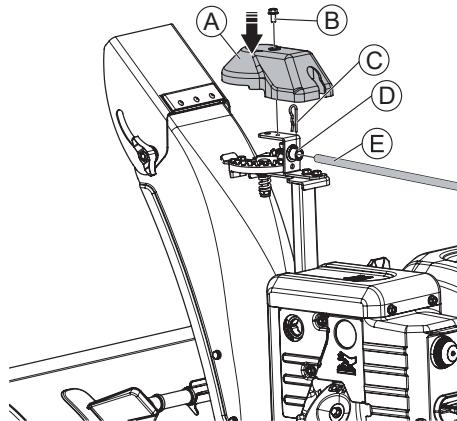
Проденьте рукоятку желоба через хомут нижней рукоятки и установите её в отверстие рулевого механизма, зафиксируйте штифтом. Установите декоративную крышку (А) и зафиксируйте ее. Используйте крепеж из бокса №13: (В) болт М6×12 – 1 шт.; (С) шплинт – 1 шт.
